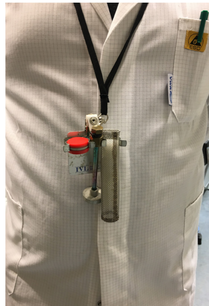
Uppsättning av provtagare för mätning av flera olika luftföroreningar. Kvävedioxid (röd knapp), svaveldioxid (blå knapp), ozon (vit knapp), flyktiga organiska ämnen (stålrör), polycykliska aromatiska kolväten (skumplast i skyddsnet) och formaldehyd (vitt rör i mitten). Förslutning på stålröret tas bort när mätningen ska påbörjas.
